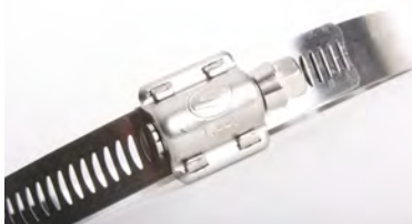
Fra 400-500 mm bespændes med 7 Nm.
