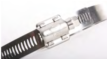
Fra 400-500 mm bespændes med 7 Nm.
