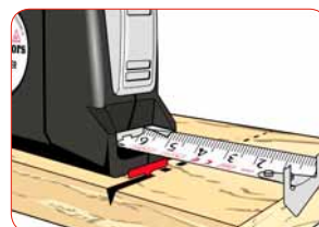
Med de kombinerede måle- og afmærkningsspidser kan du tage dit mål og overføre det med samme målespids til arbejdsområdet.
