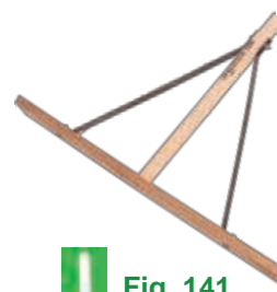
Fig. 138 Træblad til asfaltragerskaft
