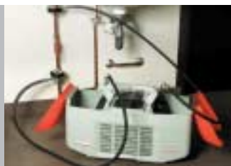
Cylindriske frysehoveder for hurtigt adapterskift. Slange i direkte forlængelse af frysehoved letter arbejdet.
